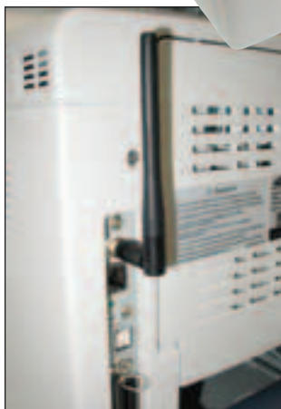
Разъемы LPT, USB и сетевой адаптер с антенной Wi-Fi принтера SAMSUNG ML-2152W
